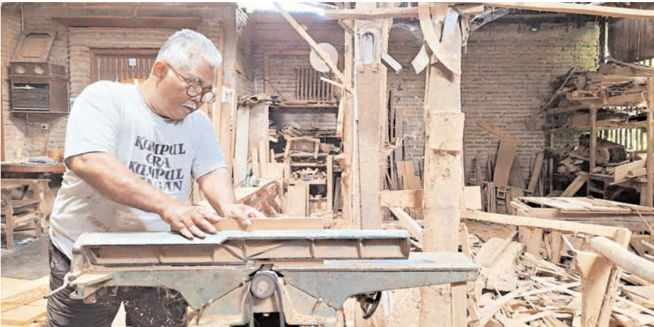
Sunardi menghaluskan sisi kayu dengan jointer bertenaga listrik.
