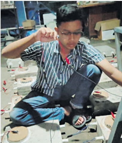
KR-Istimewa Anggota Tim PKM RE menguji korosi pada beton yang sudah dicampur dengan kaleng bekas.
