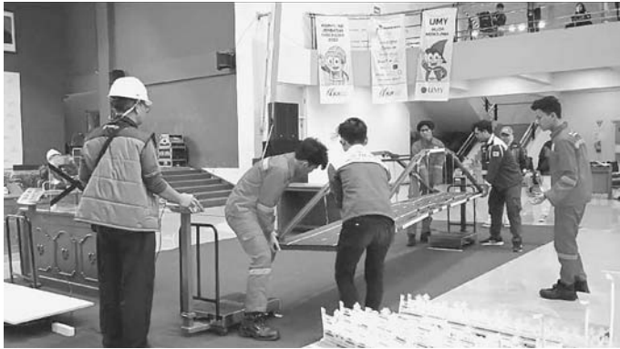
Pengujian sesi lendutan dengan target bisa menahan beban maksimal sampai 300 kg.
