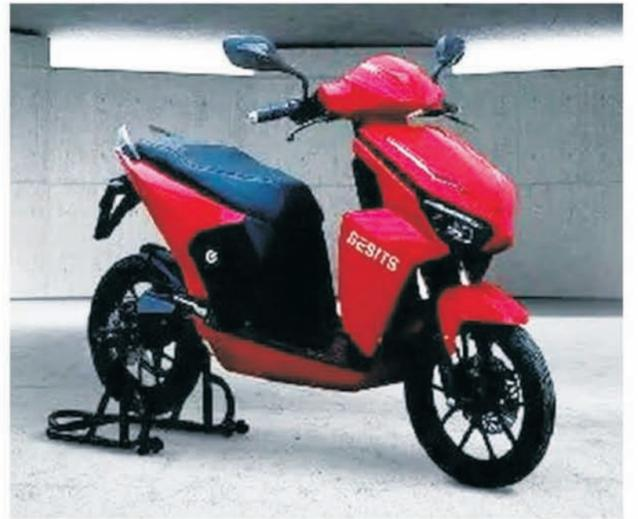
pada 3.600 rpm, dan torsi maksimal 30 Nm pada 0-2.125 rpm. Akselerasi 0-50 km per jam diklaim membutuhkan waktu 5 detik, sedangkan kecepatan puncak mencapai 70 km/jam. Jarak tempuh single battery mencapai 50 kilometer, dan dual battery mencapai 100 kilometer. Sistem pendinginan Gesits menggunakan pendingin udara. Belt penggeraknya menggunakan gates poly chain GT carbon belt. Skuter listrik ini memiliki waktu pengisian baterai sekitar 1,5-3 jam. (Ben)
